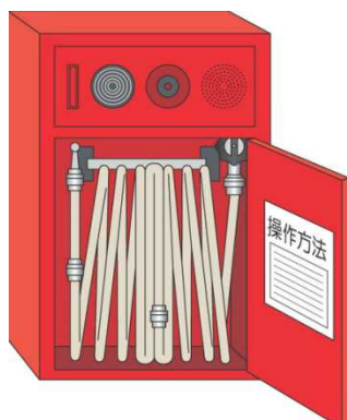
屋内消火栓設備
