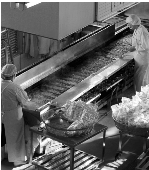
修理する給食センターの自動てんぷら揚げ機
